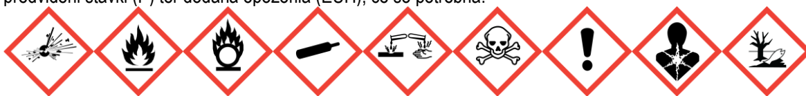
Slika 2: Označevanje po GHS (globalno harmoniziranem sistemu)
